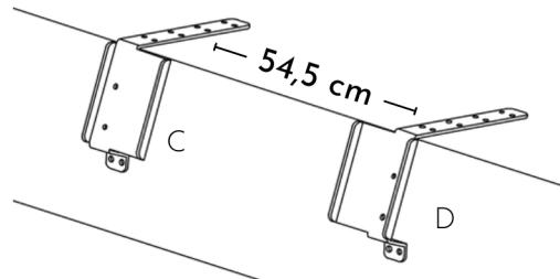
2. Kiinnitä osat B kannakkeisiin C ja D ruuveilla E ja muttereilla F.
